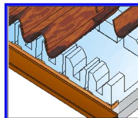
Terminato il fissaggio del listello di legno, si procede al fissaggio delle staffe di sostegno della grondaia. Queste ultime dovranno avere una forma adeguata, tale da permettergli di essere
