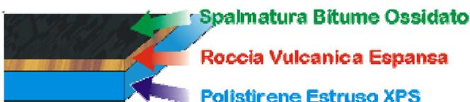
**RESFLAM®** è una lastra isolante studiata appositamente per le coperture piane impermeabilizzate con membrane bituminose, prodotta da **A.B. ISOLANTI S.p.A.** con i nuovissimi impianti in continuo, nei nuovi stabilimenti siti in Via I Maggio a Presezzo (BG).
